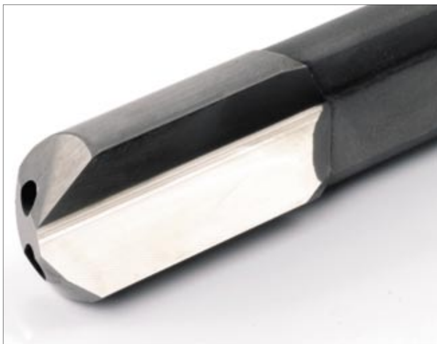
Bild: Bohrkopf eines Einlippenbohrers. Deutlich sind neben der Zerspangeometrie auch die Austrittsöffnungen der Schmier- bzw. Kühlkanäle zu sehen (Werkbild: Star Cutter Company)
